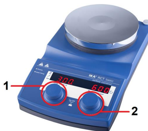
Rys. 2. Mieszadło magnetyczne (2), z funkcją grzania (1).
